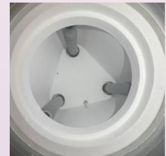
Éléments chauffants en disilicure de molybdène (en haut) et en carbure de silicium (ci-dessous). Les éléments chauffants en carbure de silicium sont résistants au vieillissement et sont donc préférables.
