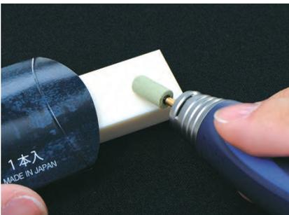
Pour modifier la forme des Dura-Green DIA ou les nettoyer, les faire tourner au contact de l'Adjuster Shofu (oxyde d'aluminium).
