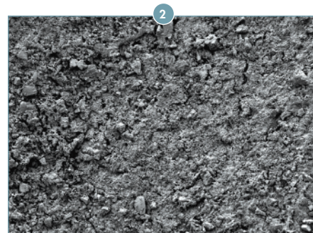
Le SEM* montre une surface en céramique après 1 minute de traitement avec Porcelain Etch Gel.
