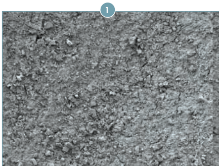
Le SEM* montre une surface en céramique avant le traitement.
