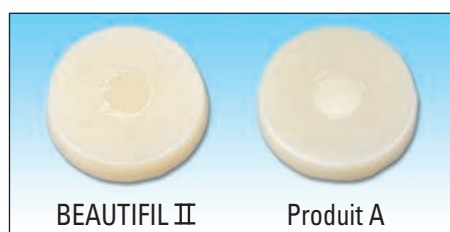
Centre non polymérisé et couronne polymérisée
